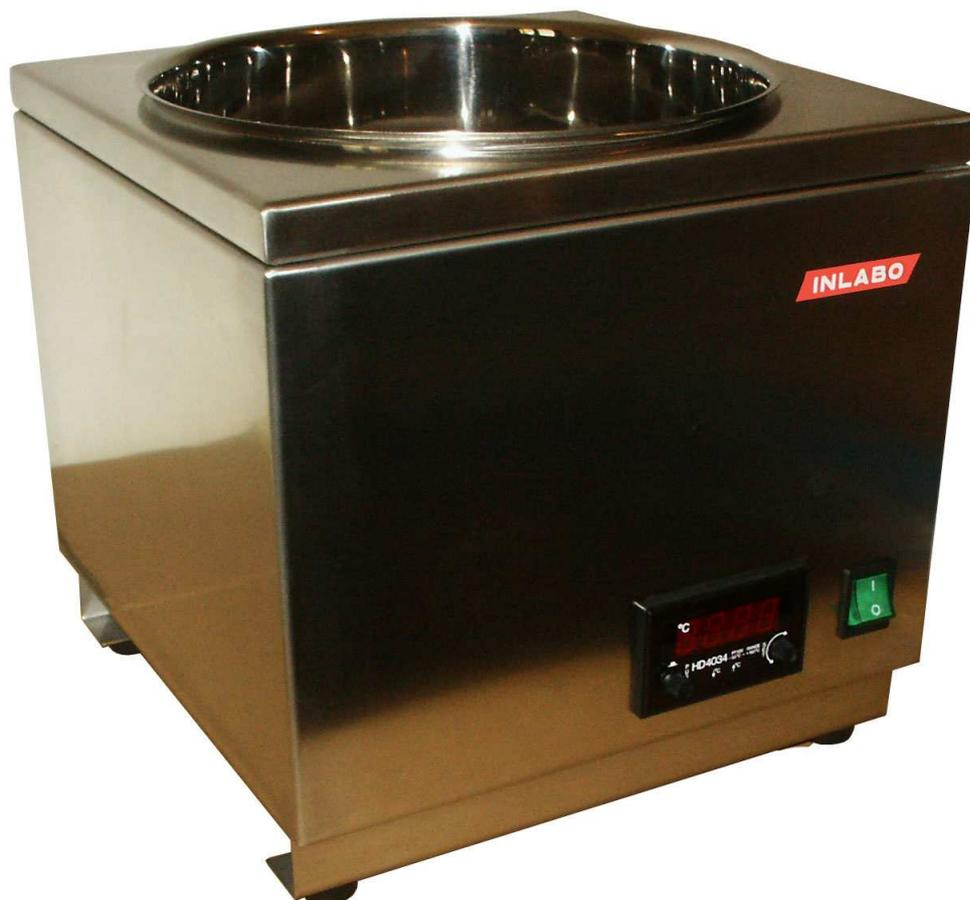
**Bagno riscaldante per evaporatori rotanti EVI**
